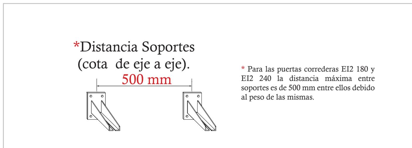
1.3. Nivelar la guía. Los soportes incluyen un espárrago para facilitar la instalación y nivelaje de la primera guía.
